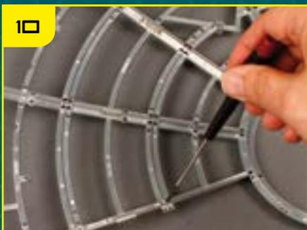
Закрепите внешний угол рамы BF-38, закрутив винт во фланец ребра жесткости.
