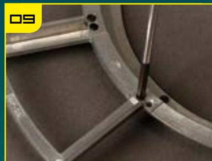
Закрепите раму BF-38, закрутив один винт в кольцо турели и зафиксировав конец ребра жесткости.
